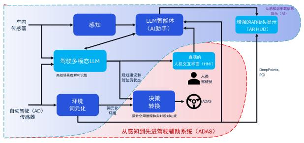
图4: 简化的车内AI系统架构以支持智能座舱、自动驾驶和先进驾驶辅助。 来源: 高通技术公司, 2025年1月。
